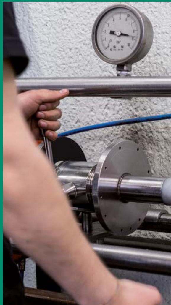
испытательный стенд давления для клапанов
